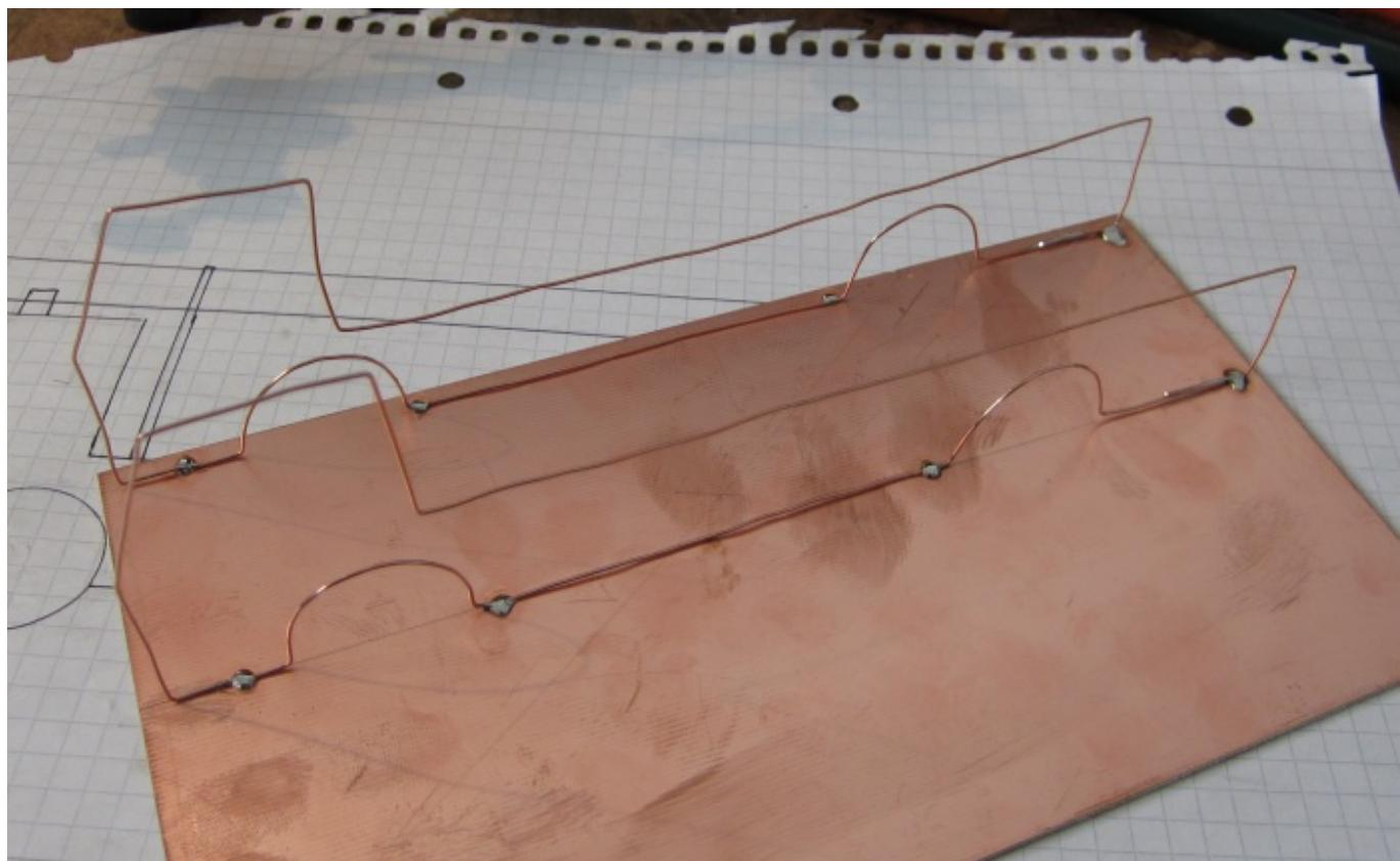
Nun die gegurteten Widerstände dem Draht entlang auflöten und abwickeln :
