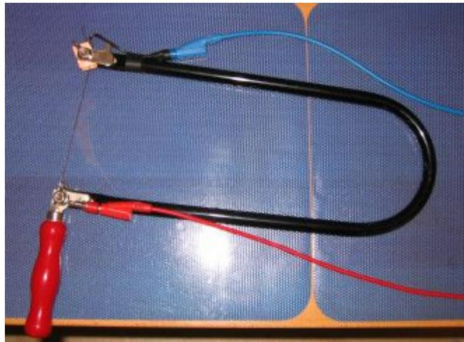
Dazu in der einen Seite eine Unterlegscheibe mit 4mm Buchse einschrauben und dicken Konstantandraht als Schneidedraht festklemmen:
