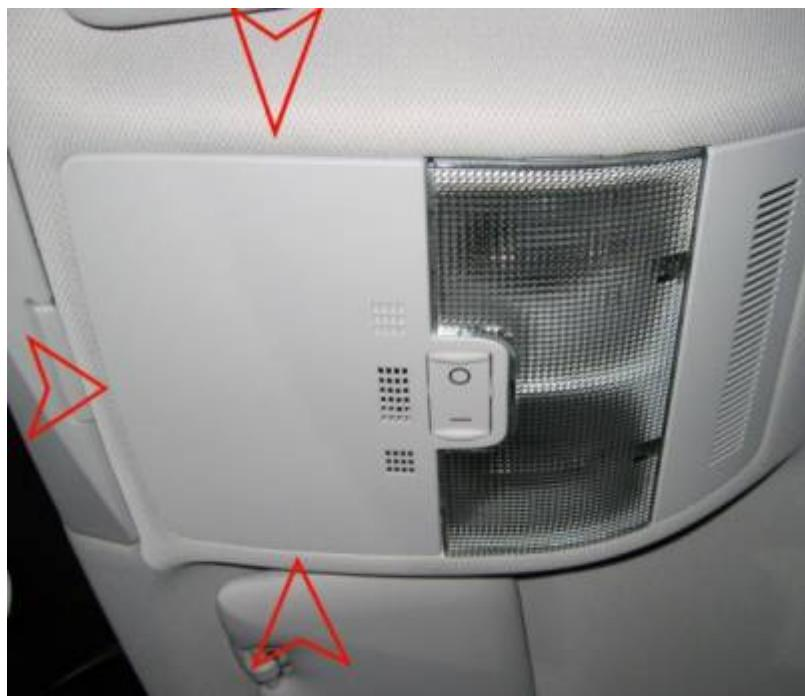
Mit einem Schraubendreher die beiden Schrauben herausdrehen und die Einheit aus dem Himmel herausnehmen:
