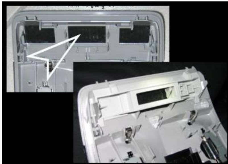
Dann den Stecker einstecken, Kabel einklippsen, Leseleuchte in den Himmel einstecken. Die beiden Schrauben wieder eindrehen sowie die Plastikabdeckung wieder aufschnappen:
