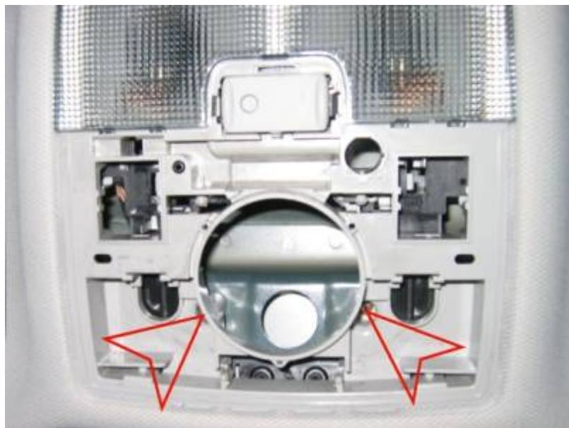
Dann den Stecker aus der Buchse lösen sowie den Plastikhalter (weiss) aus dem schwarzen Kunststoff lösen und das Kabel entnehmen :
