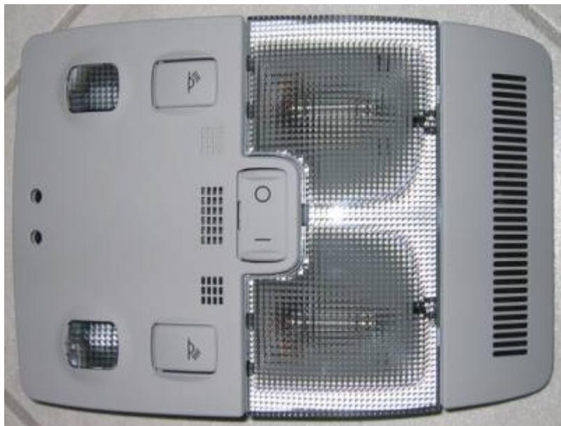
Der Einbau gestaltet sich einfach. Zuerst die Plastikabdeckung mit einem Abziehhaken oder einem Plastikkeil vorsichtig herrunterhebeln (an 4 Stellen reingeschnappt):
