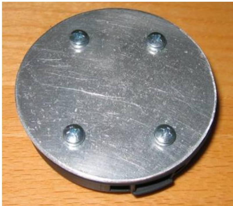
Jetzt wird in den Fuß des Halters sowie in die Mitte der beiden Alu-Scheiben ein 4mm Loch gebohrt:
