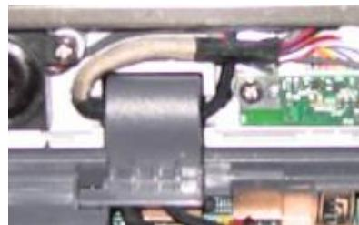
Und so sieht die Kabelabdeckung nach dem Ausbau aus:
