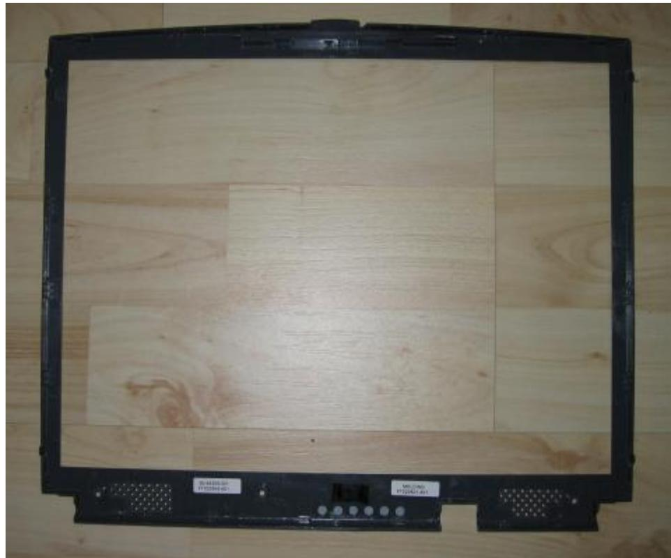
Schauen wir uns nun die Kabelabdeckung genauer an. Sie ist hinten mit Nasen eingeklipst sowie vorne mit einem Steg befestigt. Unter der Abdeckung liegen 2 umwickelte Kabelstränge zwischen Display und Rechner:
