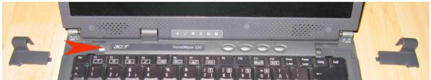
Dann kommt auch schon die „böse“ Kabelabdeckung zum Vorschein. Dort gehen die Kabel zum eigentlichen Display, den Lautsprechern, dem Mikrofon sowie der Hintergrundbeleuchtung:
