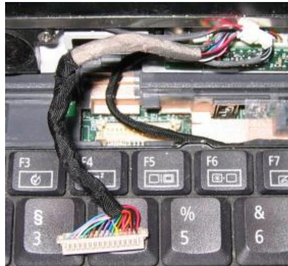
Runter mit dem Gewebe ... Dann kommt auch schon das Übel zum Vorschein. An derselben Stelle ist eine Leitung zum Mikrofon und eine zum rechten Lautsprecher abgebrochen:
