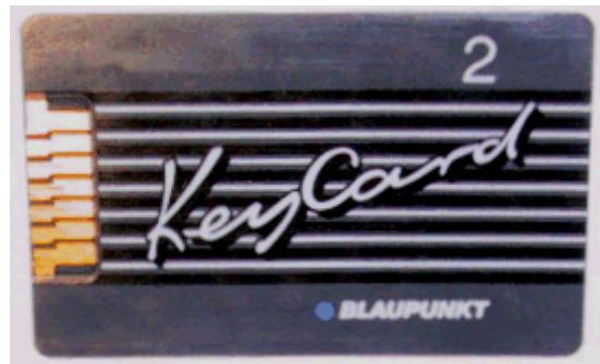
Zuerst einmal: Diese Karte enthält keinerlei Logik, Intelligenz, Microcontroller u.s.w. Die Kodierung besteht lediglich aus verschiedenen Widerstandskombinationen zwischen den einzelnen Kontakten. Die Karte selber besteht aus zwei aufeinandergeklebten Schichten. Auf der ersten Schicht sind Leiterbahnen, die vergoldeten 7 Kontaktanschlüsse und die Widerstandsverbindungen. Die zweite Schicht deckt das ganze ab und schützt die Widerstandsbahnen vor Beschädigungen.
