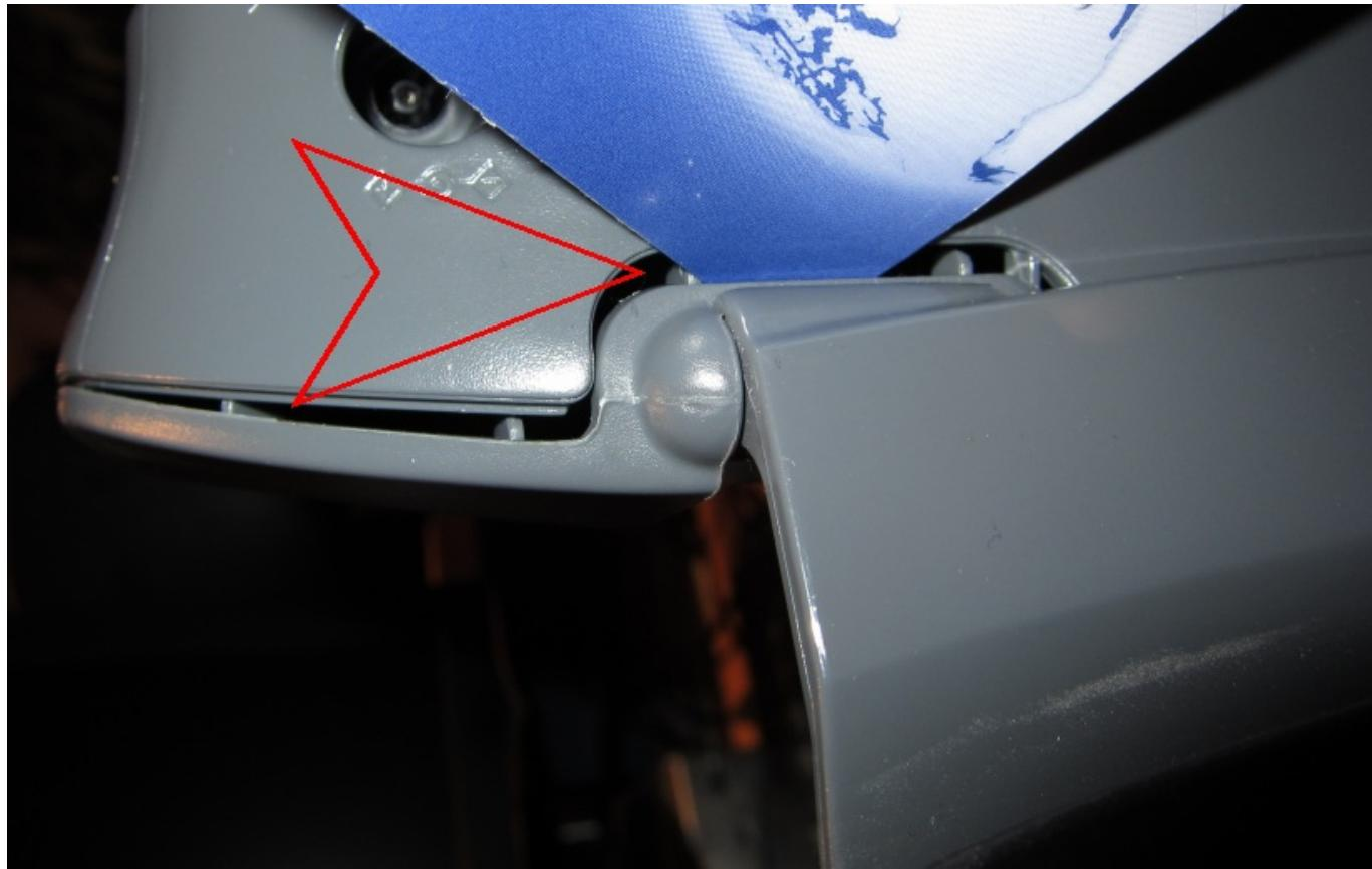
Nun kommt der schwierige Teil : Die nächsten Rastnasen sind gut zugeschnappt. Durch die entstandene Öffnung muss nun ein flacher Schraubendreher von hinten in die markierte Stelle der Lasche. Dann leicht drehen und das Gehäuse ist wieder ein Schritt weiter auf :
