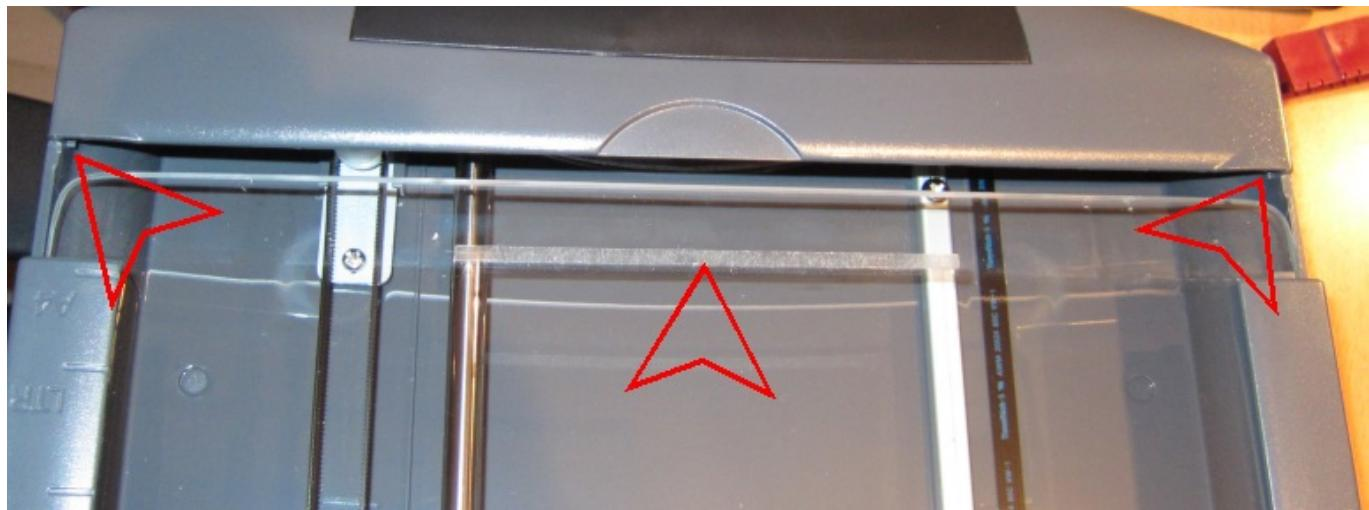
Fertig ! Damit kann das Glas abgehoben und gereinigt werden. Beim Zusammenbau die Scheibe vorne leicht schräg reinschieben und dann flach hineindrücken bis die Rastnasen zu hören sind. Abschließen dann alle Rastnasen wieder einklipsern und die Schrauben und das Flachbandkabel wieder einbauen - fertig.
