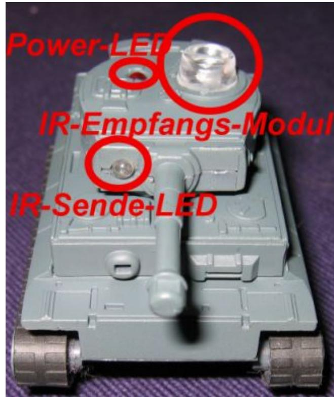
Im Turm des Panzers gibt es 3 Komponenten : - Power LED in Rot - Durchsichtiges Plastikteil (Innen konkav geformt) zur Weiterleitung der IR- Strahlung zum IR Empfänger - IR-Sende-LED zur Übertragung des „Schuss“-Kommandos
