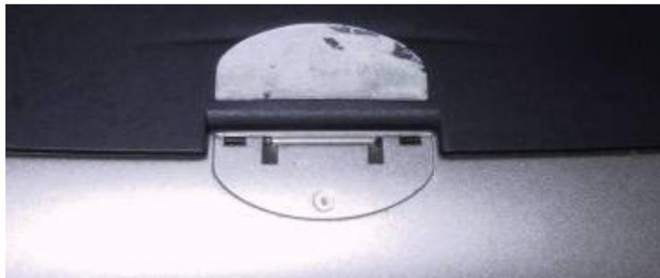
Alu entfernt, Metallstifte rechts und links sichtbar
