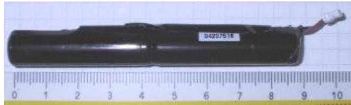
Ausgebauter Akkupack, noch mit Schrumpfschlauch
