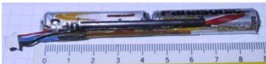
Neuer Akkupack mit angeklebtem Plastikstreifen und Thermofühler
