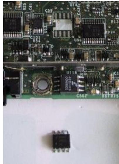
Der Chip enthält alle wichtigen Einstellungen des BIOS und ebenso das Passwort. Dieser muss nun also ausgelötet und ausgelesen werden:
