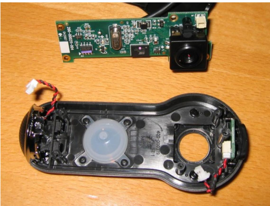
Der Autofokus ist mit einer schwarzen Plastikkappe abgedeckt. Diese ist mit 4 Rast-Nasen mit dem Objektiv verbunden. An den gekennzeichneten Stellen die Nasen leicht zur Seite drücken und das Teil abnehmen :
