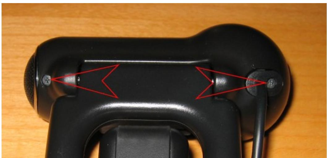
Nun 2 weiße Stecker für Mikrofon und Taster herausziehen und die 4 markierten Schrauben lösen.
