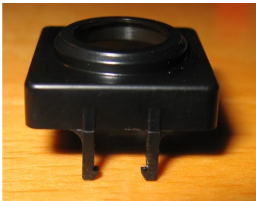
Darunter sieht man nun das eigentliche Objektiv mit Autofokus sowie der obere Ring mit den 3 Nasen zur Justierung. Dieser Drehring ist an der mit dem großen Pfeil markierten Stelle allerdings gesichert -
