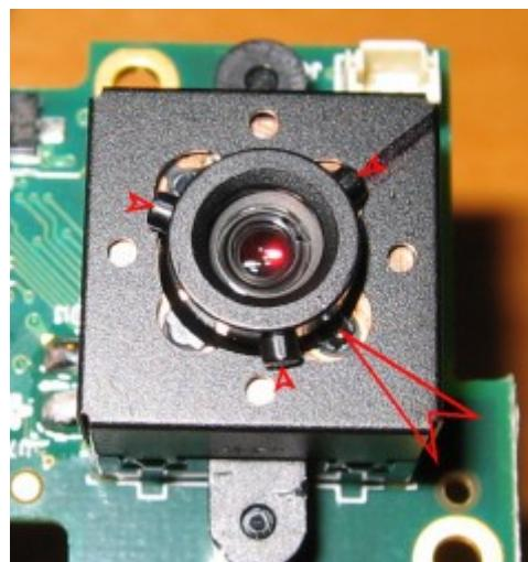
Zuerst muss der Klebepunkt entfernt werden. Dazu den Focus auf unendlich stellen und USB abziehen. Dann mit einem scharfen Skalpell von der Seite und von oben kratzen solange bis der Punkt abgeht. Vorsichtig arbeiten, sonst ist der Focus dahin. Auch darauf achten das unter dem Klebepunkt sich noch ein Widerstand befindet. Dieser sollte danach auch noch vorhanden sein.
