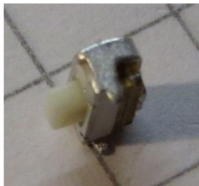
Schalter auslöten und Lötpads reinigen. Scheint ein Taster nach Masse zu sein ...
