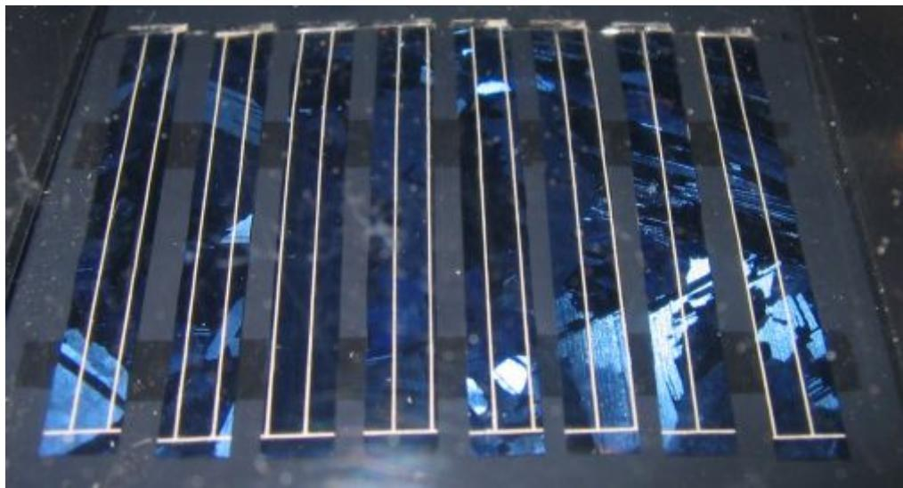
8 Bruchstücke aus den Resten fernöstlicher Solarproduktion ? ... Unter einem Baustrahler bringt das Ding im Leerlauf 4,5V sowie 22mA Kurzschlußstrom.
