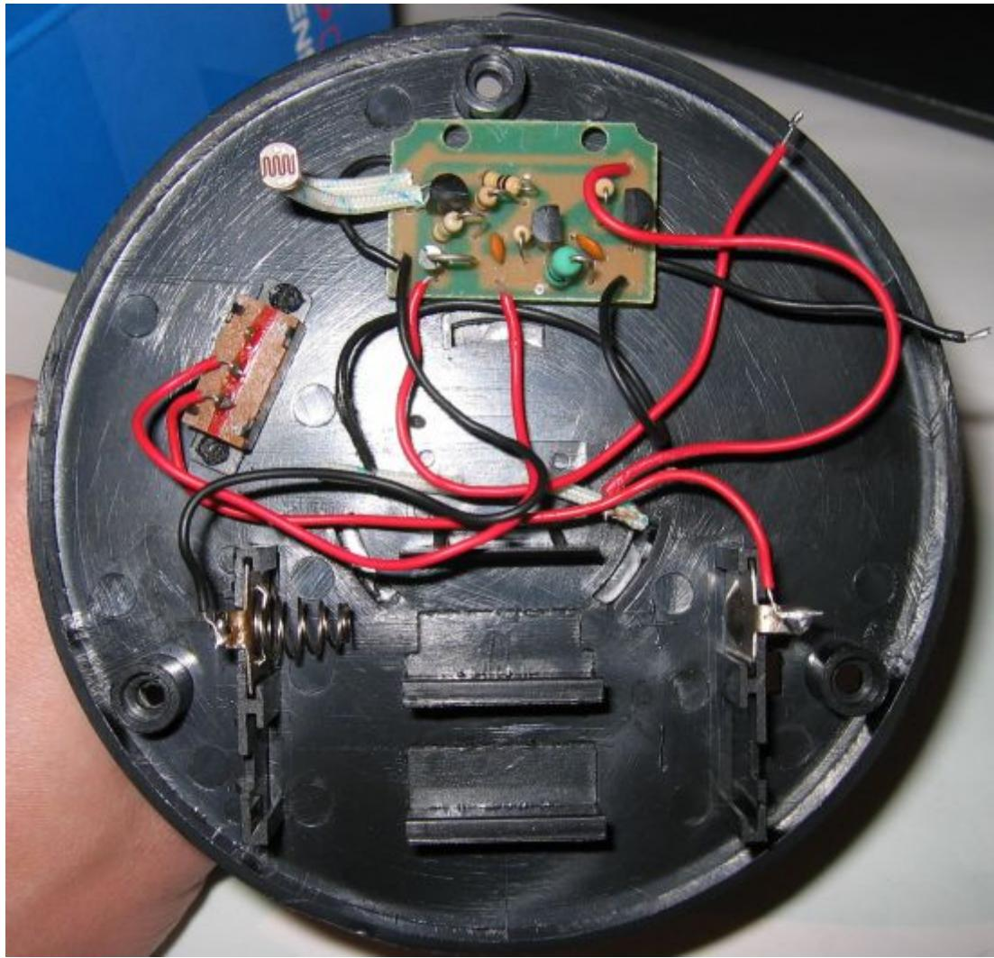
Dazu kommt noch eine einzige 600mAh NiCad Zelle zur Pufferung. Die LED in weiß ist auf der Rückseite. Der LDR kommt nach oben in Richtung Solarzelle.
