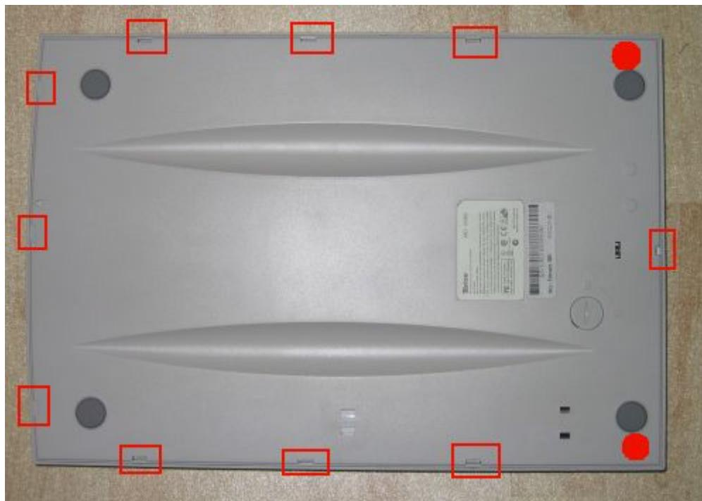
An den roten Kreisen die Schrauben rausdrehen, an den Rechtecken die Plastiknasen eindrücken und dann das ganze Gehäuse abheben.
