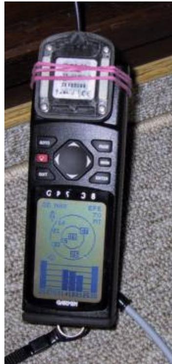
Datenkabel zwischen Garmin und dem PC. Das ganze wird über 12V versorgt, deswegen der Bleiakku
