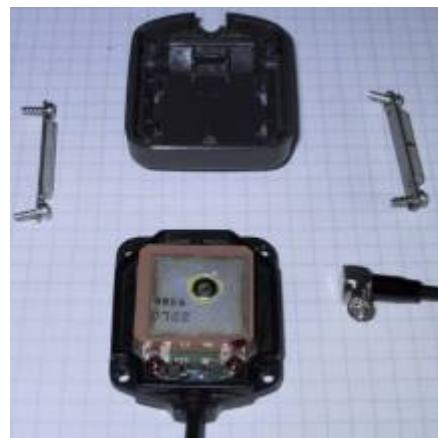
Anschließend kann die Platine mit der Keramikantenne dem Gehäuse entnommen werden.
