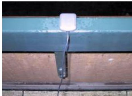
Adapterkabel zwischen den Anschlüssen der Antennen und Versorgung der Innenleiter mit +5V.
