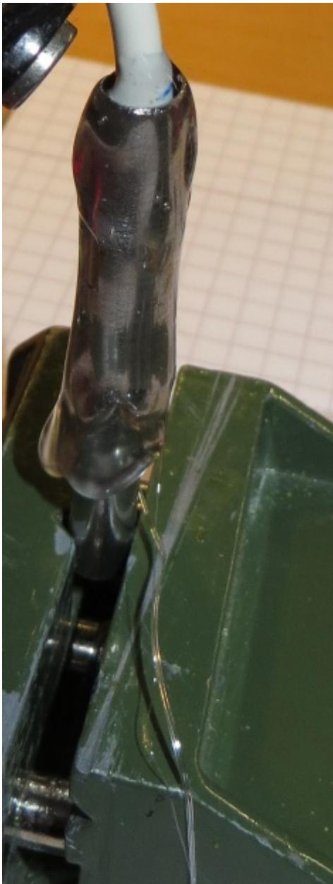
Nach dem erkalten den überstehenden Heisskleber einfach abschneiden, Schrumpfschlauch drüber und fertig :
