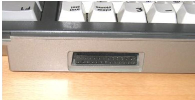
Sollte das Kabel mal defekt sein, reicht ein einfaches 1:1 Kabel, wobei 2 Pins nicht belegt sind (2 und 25).
