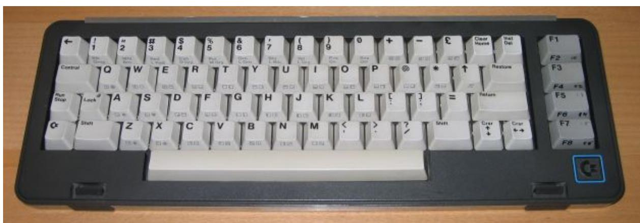
Die Tastatur ist mit einem mehradrigen Rundkabel mit zwei 25pol. SUB-D Steckern am eigentlichen SX64 angeschlossen:
