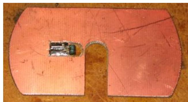
Die Platte wird dann auf der Rückseite einfach hart mit dem Motorgehäuse verlötet und fertig ...
