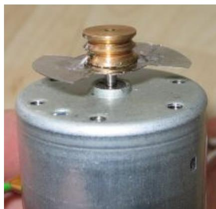
Als nächstes muss eine Befestigung für unseren Rotor angebracht werden. Hier war die simpelste Lösung das zentrische Auflöten einer Messingmutter:
