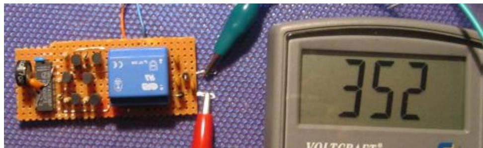
Jetzt kann die Feldmühle abgeglichen werden. Schließt man beide Platten kurz, so kann die Ausgangsspannung auf 0 eingestellt werden. Mit dem zweiten Poti lässt sich die Ausgangsspannung bei bekanntem Feld einregeln.
