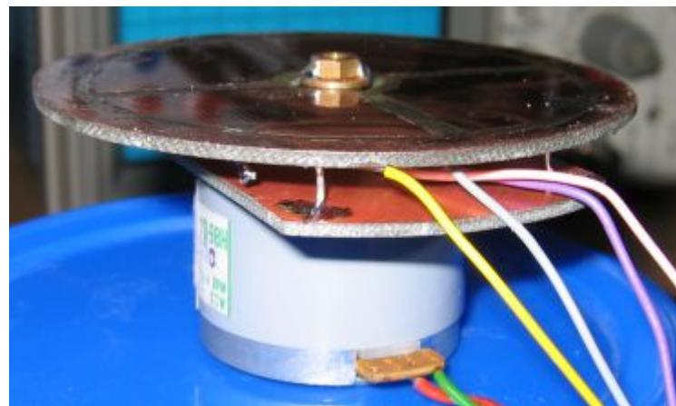
Die Mechanik-Einheit kann dann mit dem „Elektronik-Pack“ zusammengelötet werden. Kupferkaschiertes Material und eine Schere helfen hier weiter:
