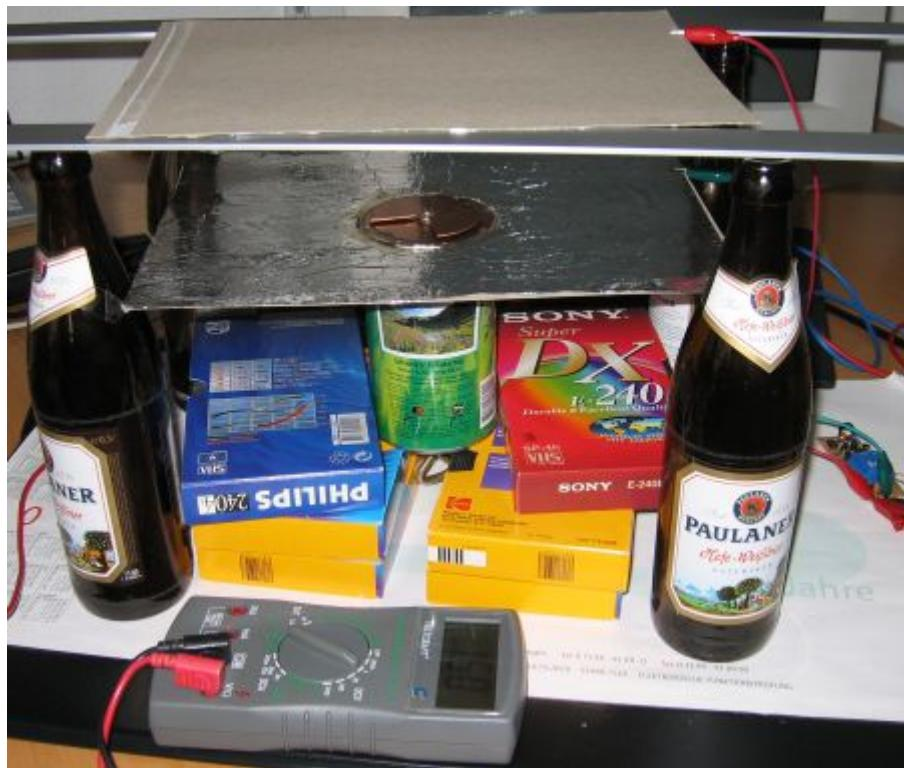
An beide Platten muss nun eine bekannte Spannung angelegt werden. Ich habe aus meinem Geigerzähler-Vorgänger-Projekt das Hochspannungsnetzteil entnommen, hiermit konnte ich dann Spannungen von 50...350V an die Platten anlegen, indem ich die Betriebsspannung von 1..5V mit einem Netzteil eingestellt habe.
