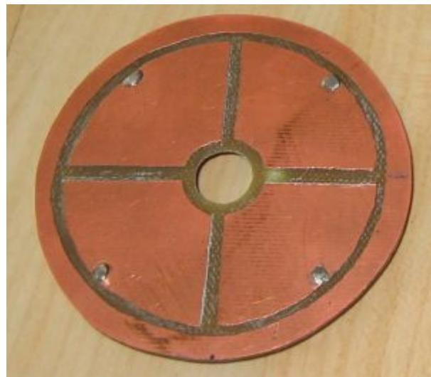
Auf der Rückseite werden die jeweils 2 gegenüberliegenden Messplatten miteinander mit geschirmten Leitungen verbunden. Zur späteren Auswertung der Stellung des Rotors wird noch eine Infrarot-LED aus einer Lichtschranke eingebaut:
