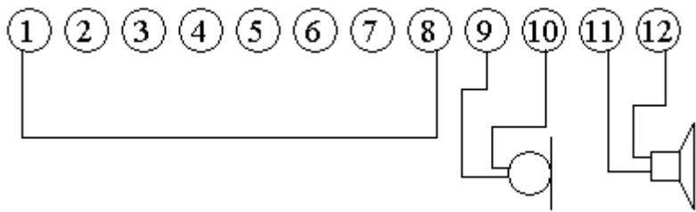
Schaltung des Siemens S35 Headset mit PTT-Funktion:
