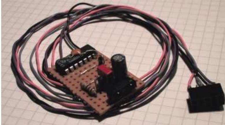
Benötigt werden dafür ein paar Widerstände, Kondensatoren und der IRDA-Transceiver TFDS4500 von TEMIC. Den gibts z.B. bei Conrad. Zusätzlich hab ich noch einen 74HC00 draufgesetzt, damit die ganze Sache auch bei größeren Kabellängen noch einwandfrei funktioniert.
