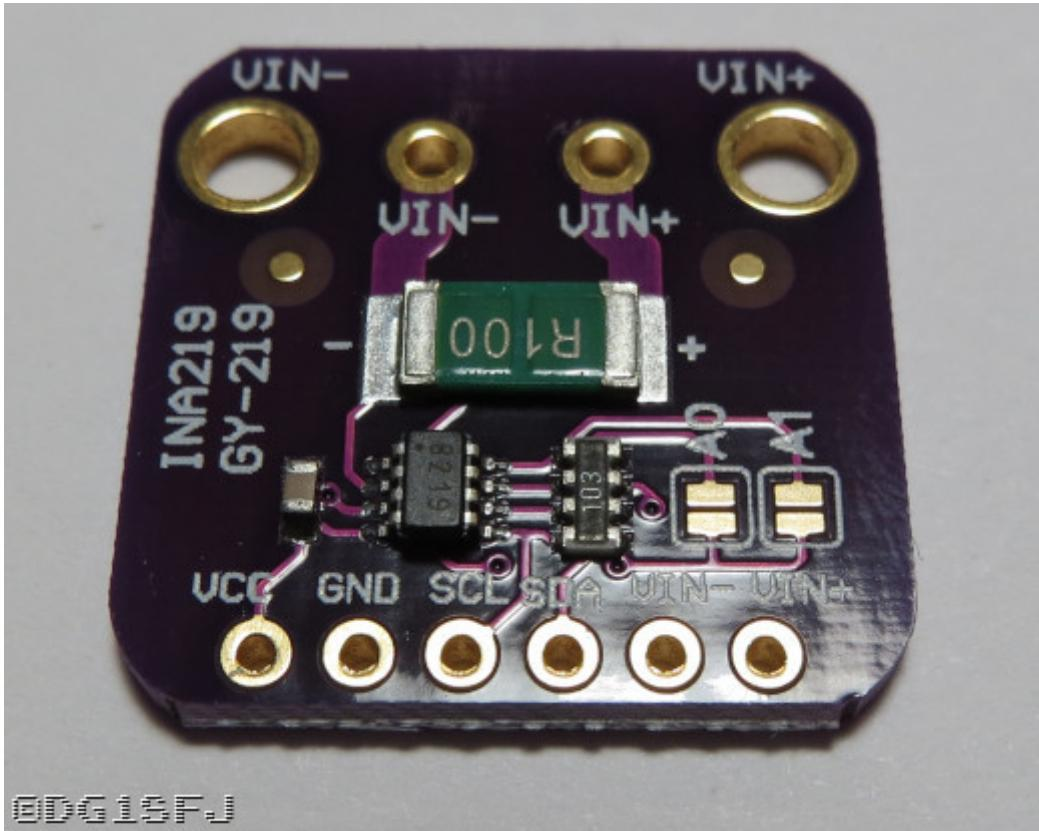
Der Vorteile dieses Mini-Module ist das der INA219 mit Shunt fertig aufgelötet ist und man per I2C die Strom und die Spannungswerte auslesen kann. Mit den Lötbrücken rechts kann man noch die I2C Adresse verstellen wenn man mehrere Module zeitgleich am Bus hat.
