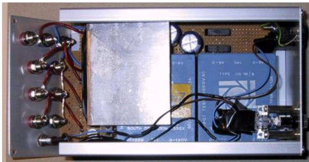
Ein Blick ins Innere. Der Aluwinkel links ist ein gemeinsamer Kühlkörper für alle Spannungsregler. Und da in meinen Schaltungen ohnehin (ausser im Fehlerfalle:-) nie große Ströme auftreten, reicht das völlig aus.
