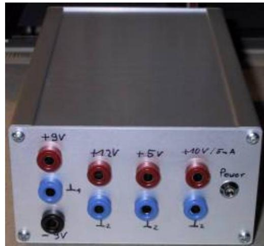
Es stellt +9V für OP-Schaltungen zur Verfügung, aber auch die häufig benötigten +12V und +5V. Als kleines Gimmick gibts noch eine hochgenaue Referenzspannung von +10V dazu.
