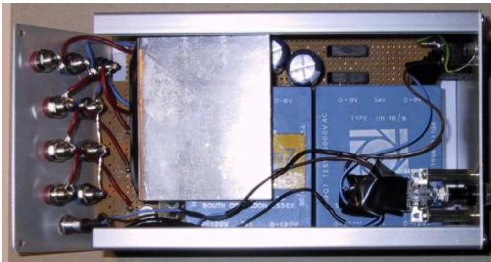
Printrafo, Gleichrichter, Elko, 2 Spannungsregler und die Referenzquelle
