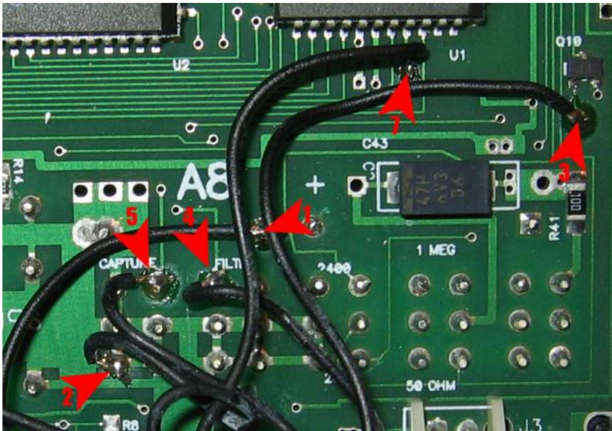
Diese Leitungen werden nun den Nummern entsprechend an den PIC-Controller angelötet:
