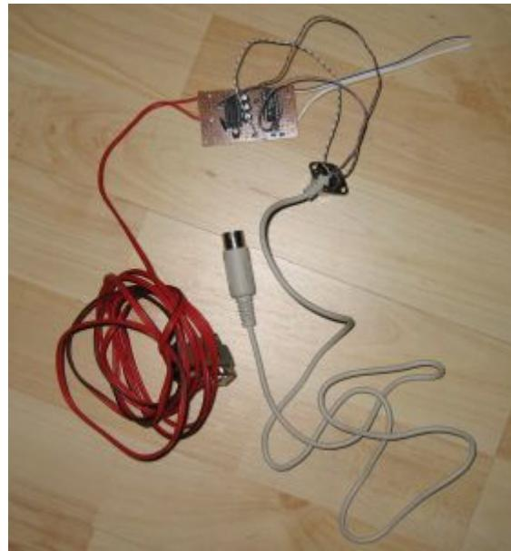
Am zweiten PC stellt man nun die Schnittstelle auf 9600Baud, 8 Datenbits, odd Parity, 1 Stop-Bit, kein Handshake und schon gehts los !
