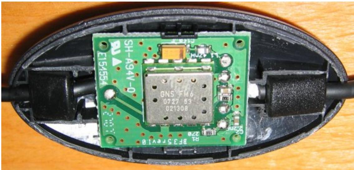
Die Rückseite ist gar nicht bestückt und hält nur die 4 Anschlusskabel sowie das schwarze Antennenkabel rechts:
