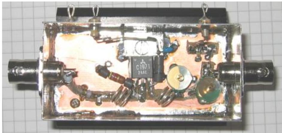
Der eigentliche Verstärker ist ein 2SC1971, ein Mitsubishi RF Power Transistor. Aus dem Datenblatt kann man die Eingangs und Ausgangsimpedanzen entnehmen:
