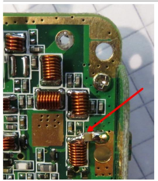
145MHz mit Einbau 33pF : High : 2,45W am Wattmeter
