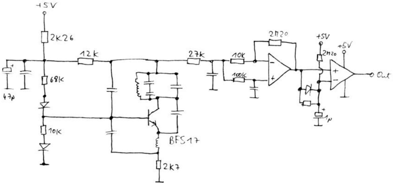
Die eigentliche Demodulation geschieht bereits im HF-Teil, sodass die Information durch simple Tiefpassfilterung gewonnen werden kann. Die 2 folgenden IC's dienen nur noch zum Mitführen der Schaltschwellen. So kann ständiges QRM nicht zum auslösen des Schaltvorgangs führen.
