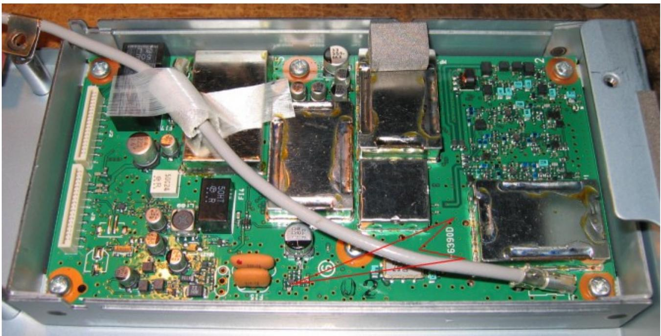
Hier mit einem geschirmten Kabel (z.B. RG174) nach draussen durch die Lücke (unten rechts) im Schirmgehäuse :
