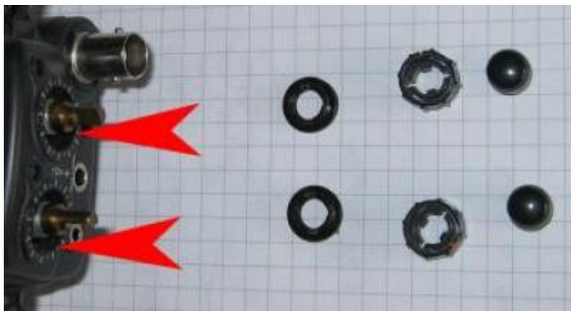
Auf der Rückseite des Gerätes die 3 Schrauben lösen, ebenso wie die kleine Schraube an der Seite beim Antennenanschlúá. Vorsichtig das Gehäuse öffnen. Nun die Hälfte mit der LCD-Anzeige nach
