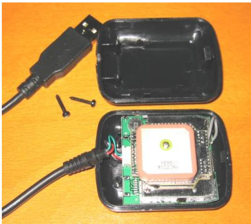
Sieh an : In der BU-303 GPS-Maus mit USB steckt ein EM-401 Empfaenger- Board. Dieses ist mit 2 Steckanschluesen ausgeruestet, wobei je nach Auslieferung (wahrscheinlich unterschiedliche Kabelbelegung) nur einer bestueckt ist ?!
