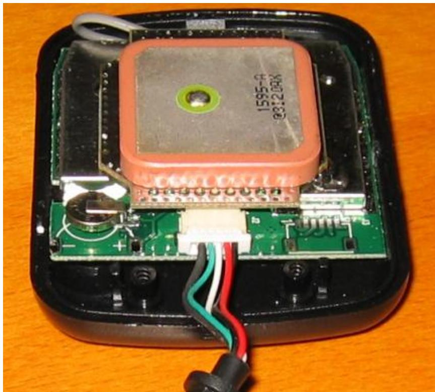
Die Knopfzelle entpuppte sich nach einer Untersuchung als eine „Electrical Double Layer Capacity DYNACAP“. Der Typ ist 3.3V mit 0.22F, 6,8mm Durchmesser, 2,1mm Hoehe. Datenblatt gibts hier : [http://www.elna.co.jp/en/ct/pdf/ds\\_dske.pdf](http://www.elna.co.jp/en/ct/pdf/ds_dske.pdf) [http://www.elna.co.jp/en/ct/pdf/dl\\_datae.pdf](http://www.elna.co.jp/en/ct/pdf/dl_datae.pdf)
