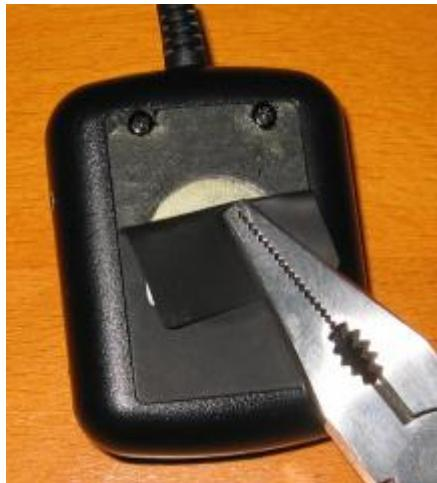
Dann beide Schrauben rausdrehen und die beiden Gehaeuse- halbschalen trennen. An der dem Anschluss gegenüberliegenden Seite ist eine Kunststoffnase eingeklippt.
