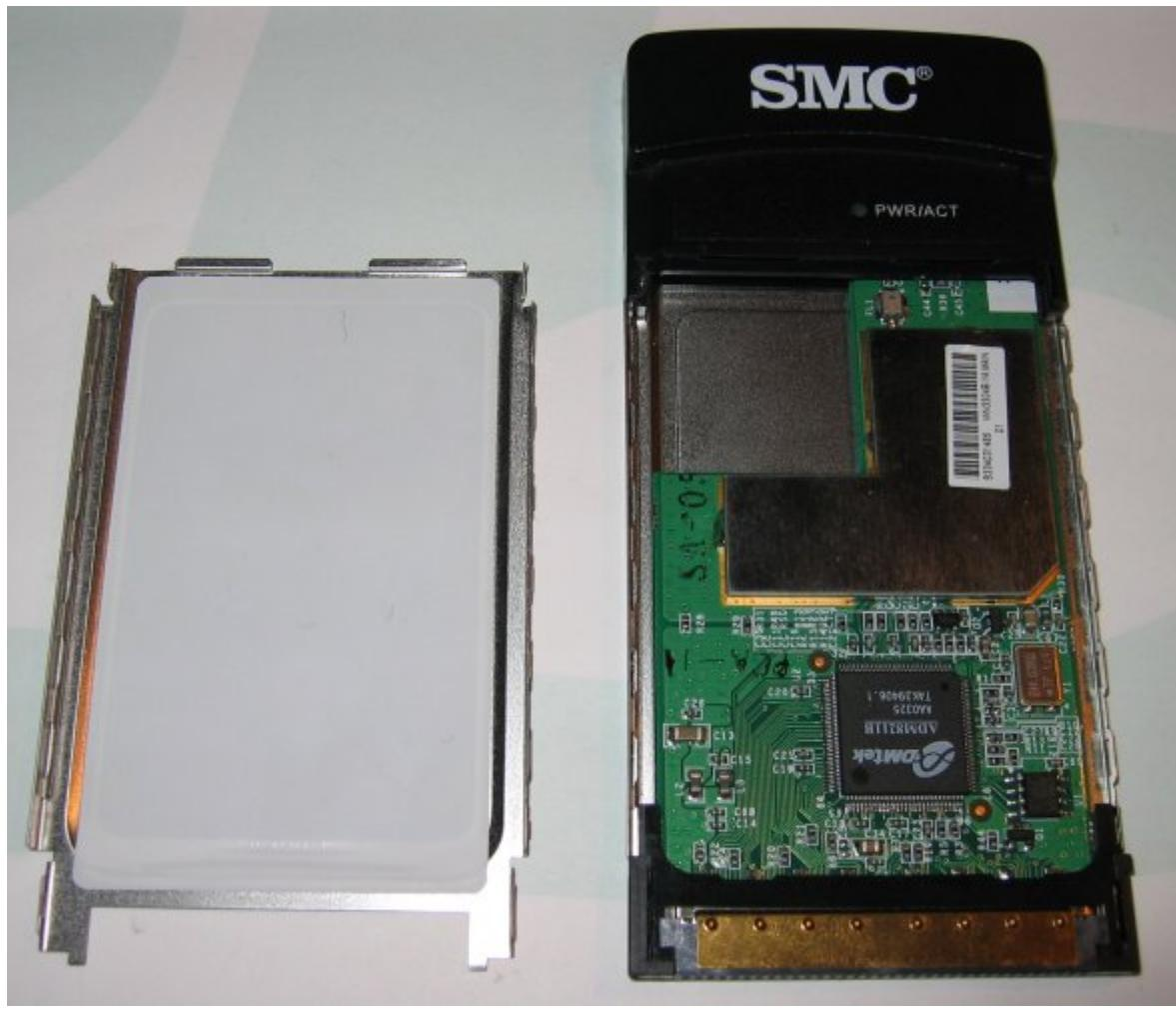
Nun wird die Karte aus dem schwarzen Gehäuseteil genommen und die gedruckte Antenne lokalisiert. Hier den Kondensator C55 sauber entlöten.
