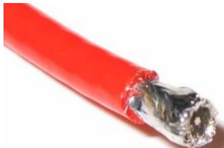
Bei gutem HF-Kabel läßt sich dann dieser Schirm mit einem scharfen Messer abtrennen.
