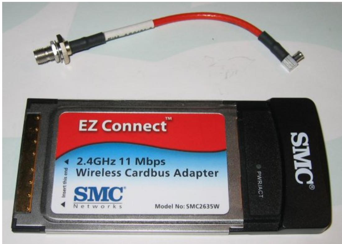
Zuerst wird die Karte geöffnet. Das geht am besten mit den Fingernägeln, welche in die Falz der Seiten gesteckt werden. Dann lässt sich das Deckelblech gut abnehmen.
