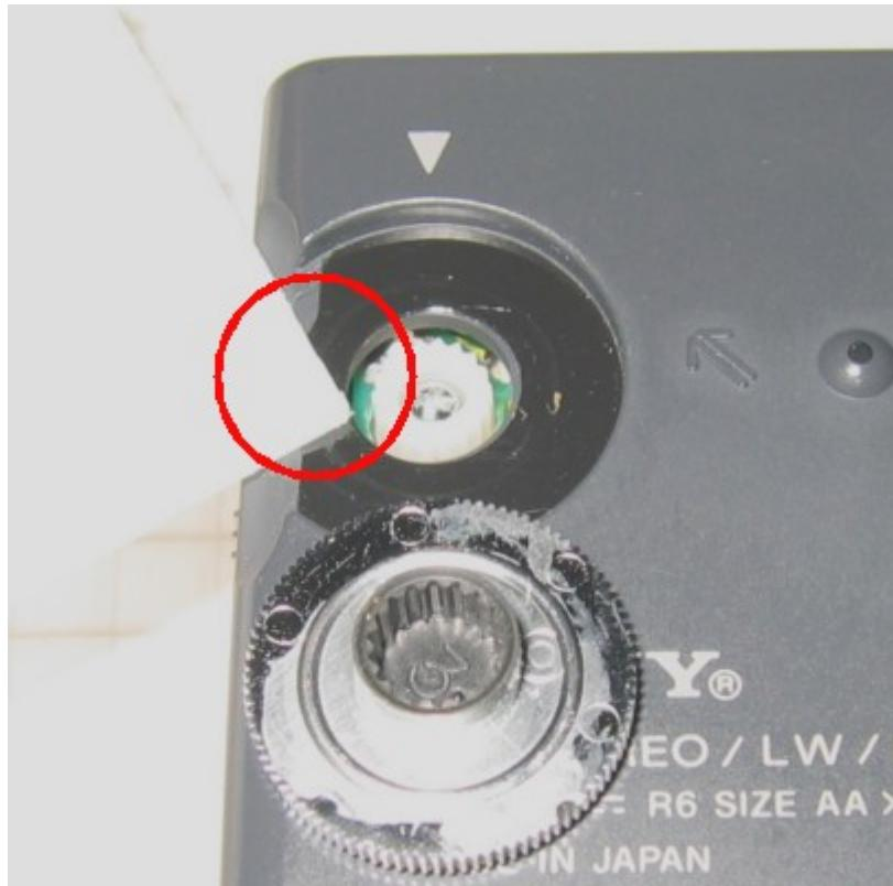
Anschließend vorsichtig den schwarz bedruckten Plastikkleber abfummeln und die darunter liegende Schraube herausdrehen :
