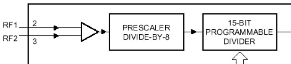
Damit hätten wir an den Pins 2 und 3 die gewünschten Signale. Über einen kleinen HF-tauglichen Koppel-C kann nun das Signal auf einen Frequenz-Zähler mit 50Ohm gegeben werden.
