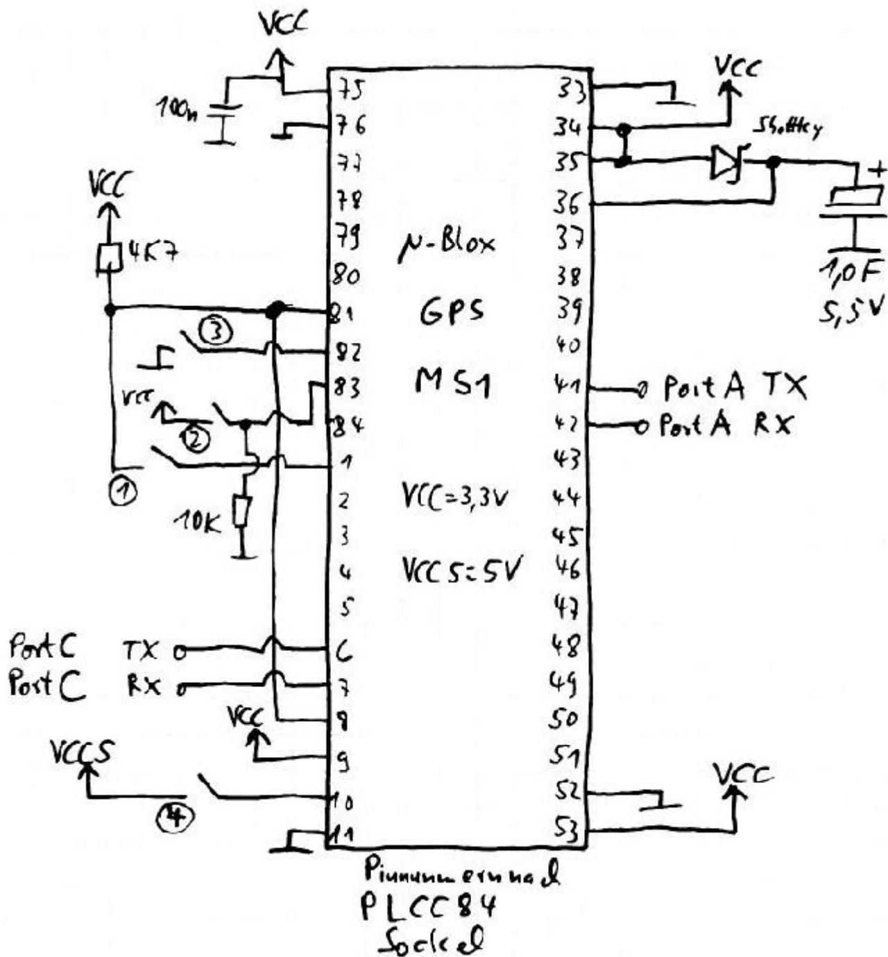
Mit den 4 Schaltern lässt sich das Modul noch zusätzlich steuern, wobei ich die Schalter immer in folgender Stellung lasse:
