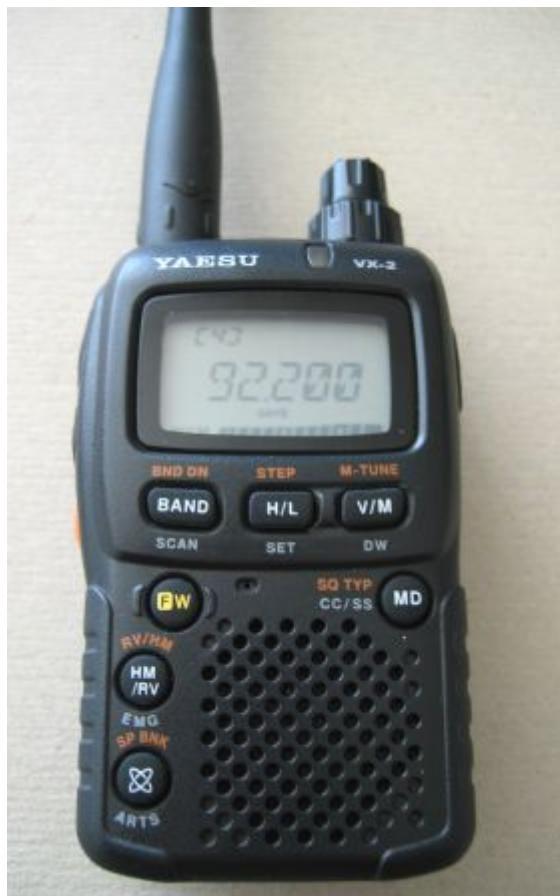
Zuerst Gerät öffnen : Dazu Batterie hinten raus, beide Schrauben lösen. Oben dann die Antenne, die MIC-Gummiabdeckung sowie die beiden Drehknöpfe abziehen.
