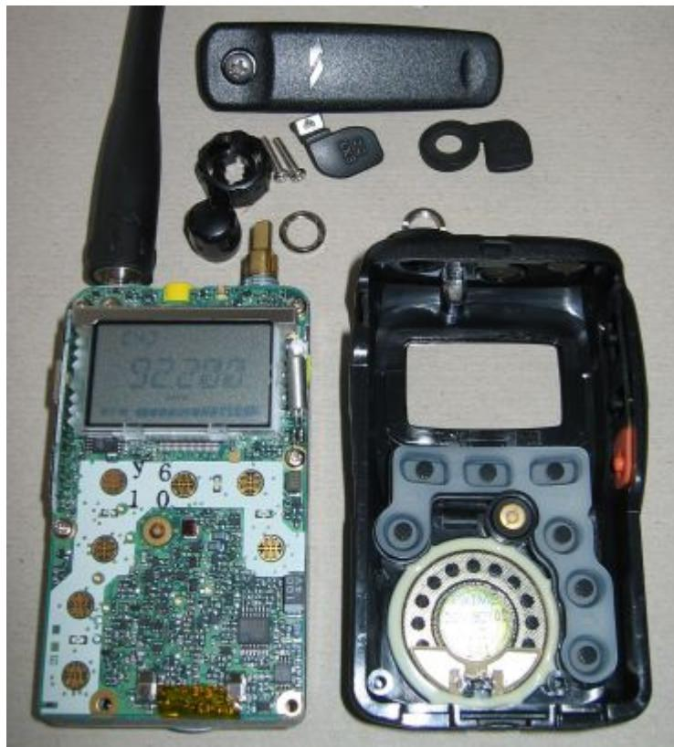
Hier zeigt sich dann auch schnell das Übel - der Lautsprecher wird nur mit Federkontakte angeschlossen. Das sorgt für mechanischen Abrieb und verhindert weiteren guten Kontakt auf Dauer.
