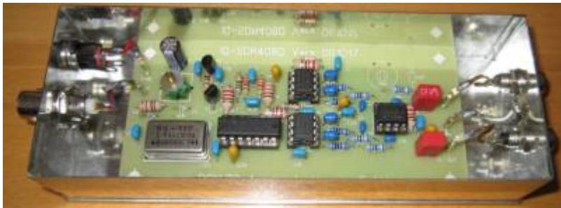
Austauschen muss man den Quarzoszillator durch einen mit 1,8432MHz. Damit liegt die Empfangsfrequenz zwar grob bei 460kHz aber den Offset kann die Software korrigieren.
