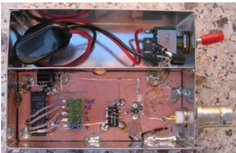
Teil 1 : Oszillator mit TTL-Out sowie Teiler für Wiederholraten von 4/2/1/0,5/0,25 MHz :
