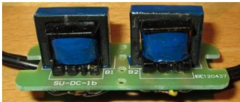
Die ausgelötzten Übertrager kann man nun in der Zielschaltung einbauen - oder wenn Platz ist schon ins Funkgerät oder die Soundkarte oder in ein extra Kästchen mit passenden Kabeln. Den Rest
