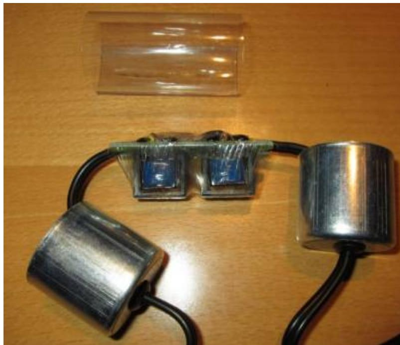
Prima, da sind die Übertrager. Auf der Unterseite noch die Gummiartige Schicht von den Lötpads abheben und per Entlötliste die beiden Übertrager ausbauen.
