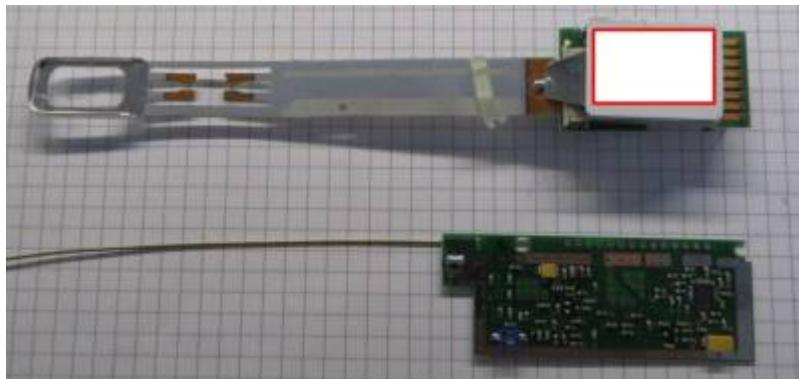
Schaut man sich die Hauptplatine im GPS-Bereich näher an erkennt man ein Eingangsfilter und 3 Verstärkerstufen mit Filtern dazwischen.
