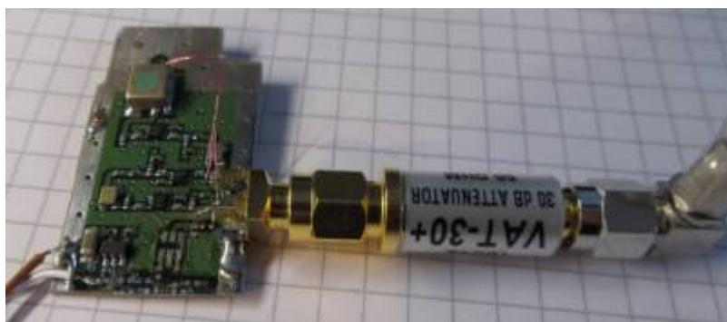
Der Umbau ist einfach : An Punkt 1 Balun entfernen, Bauteil 2 entfernen und Drahtbrücke einsetzen die auch zeitgleich zur Ausgangsbuchse geht und etwas weiter, am ehemaligen Antenneneingang ein Stück Kupferlackdraht anlöten und mit den beiden Drähten nahe beieinander eine winzige Koppelkapazität herstellen. Damit wird ein Teil des Ausgangssignals wieder auf den Eingang zurückgeführt und so wird aus dem Verstärker ein Oszillatior.
