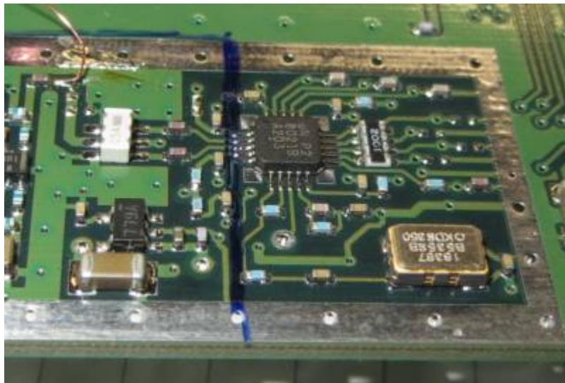
Dann braucht nur noch den Versorgungsanschluß (U größer 3,3 Volt) und eine SMA-Buchse. Der SMD-Balun und ein paar Teile unten können entlötet werden. Auf dem Bild sieht man noch ein 30dB Dämpfungsglied.
