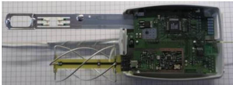
Und auf der Unterseite befinden sich noch die Senderplatine und die Sensorplatine :
